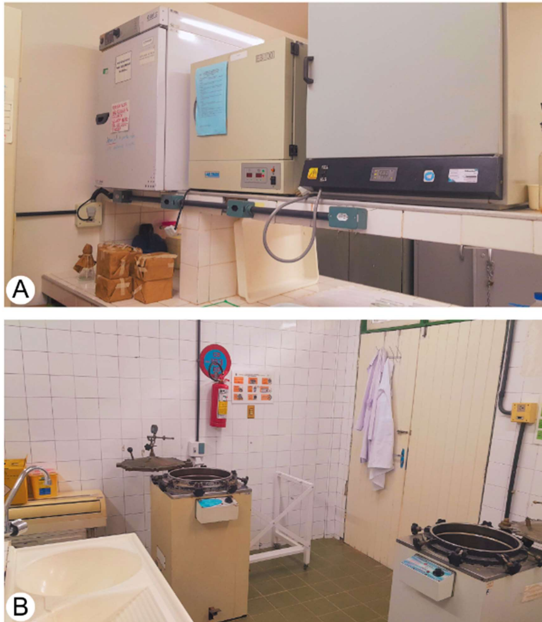
Figura 4: Sala anexa do LDIC-UFRPE. (A) À esquerda, observa-se a estufa para secagem utilizada na rotina e material recém esterilizado embalado a ser inserido nela; (B) Vê-se a autoclave utilizada para desinfecção e, à direita, a autoclave utilizada para esterilização.
