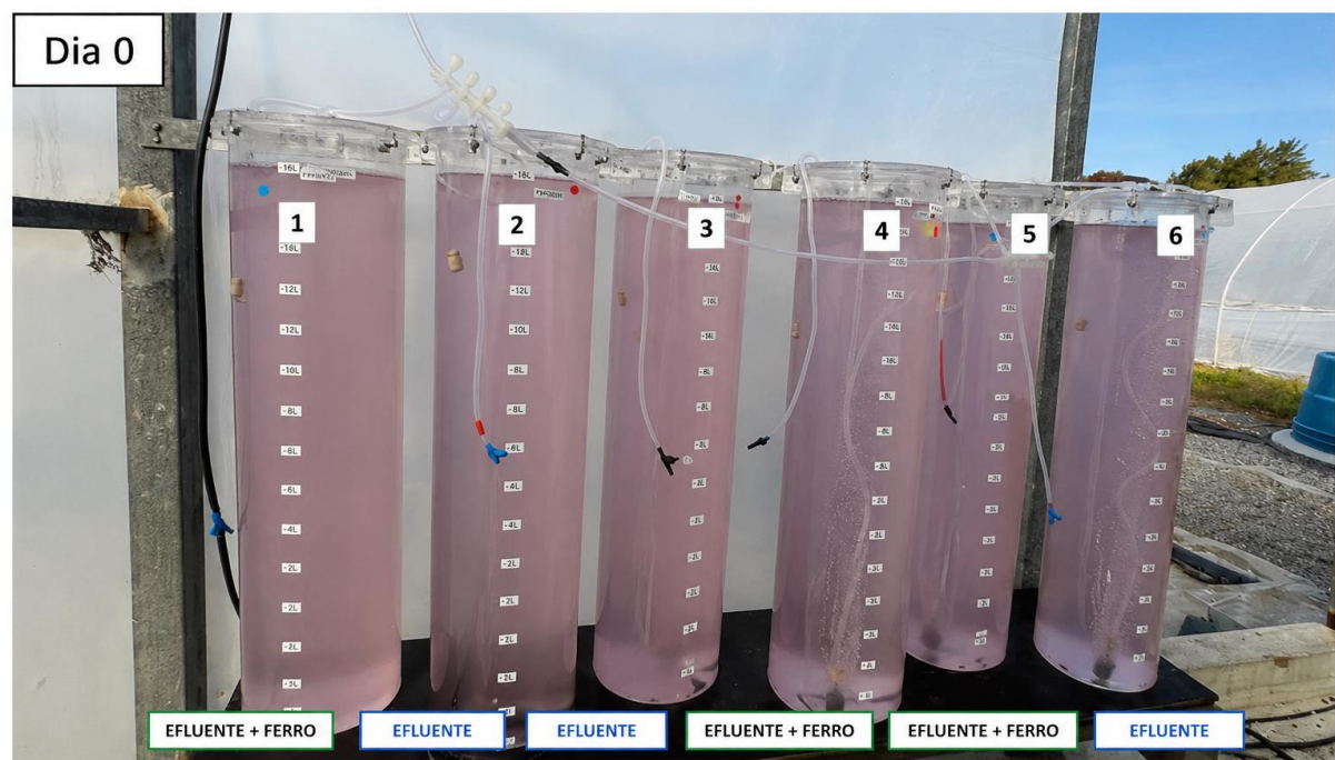
Figura 6. Disposição dos reatores dos tratamentos Efluente e Efluente + Ferro no Dia 0 do experimento em grande escala, evidenciando a distribuição das unidades experimentais em triplicata.
