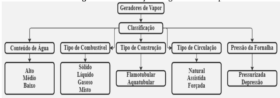
Figura 1 - Classificação dos geradores de vapor.
