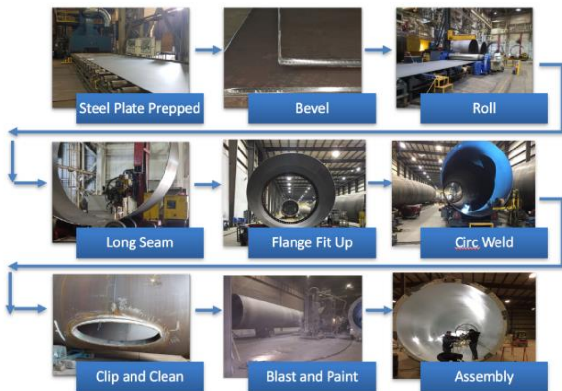
Figura 1 - Etapas do processo de fabricação de torres eólicas.
