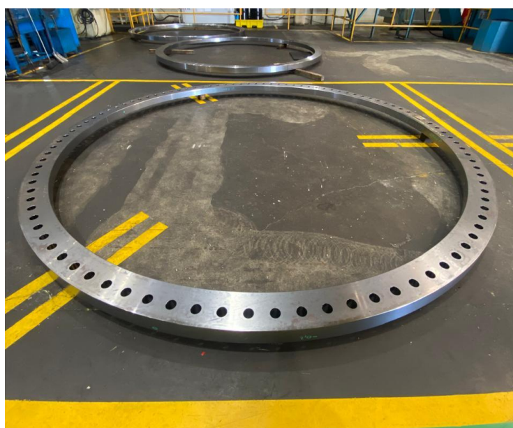
Figura 19 - Flange recém usinado e soldado.
