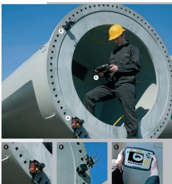
Figura 9 - Monitoramento da planicidade de flanges com sistema Easy-Laser.
