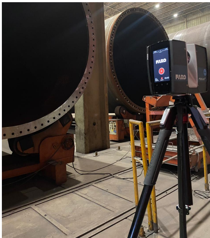
Figura 11 - Procedimento de medição com FOCUS na linha de produção.
