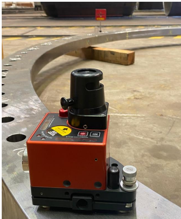
Figura 10 - Uso do Easy-Laser no controle dimensional de flanges.
