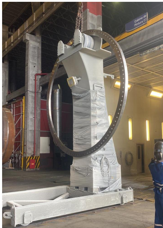
Figura 23 - Flange apoiado na vertical.
