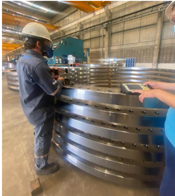
Figura 20 - Flanges empilhados para medição de Easy Laser.
