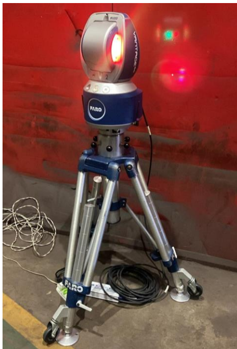
Figura 12 - Aplicação do Laser Tracker em ambiente fabril.
