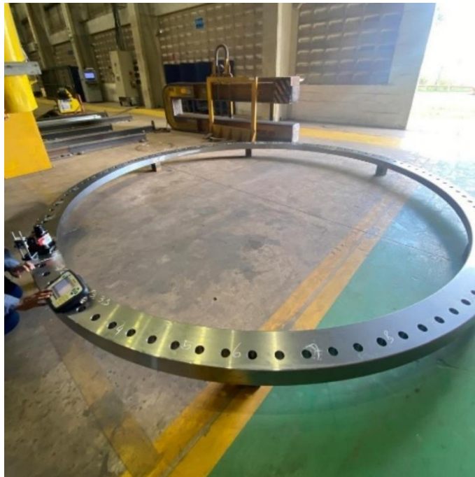
Figura 21 - Flange apoiado em tacos metálicos.
