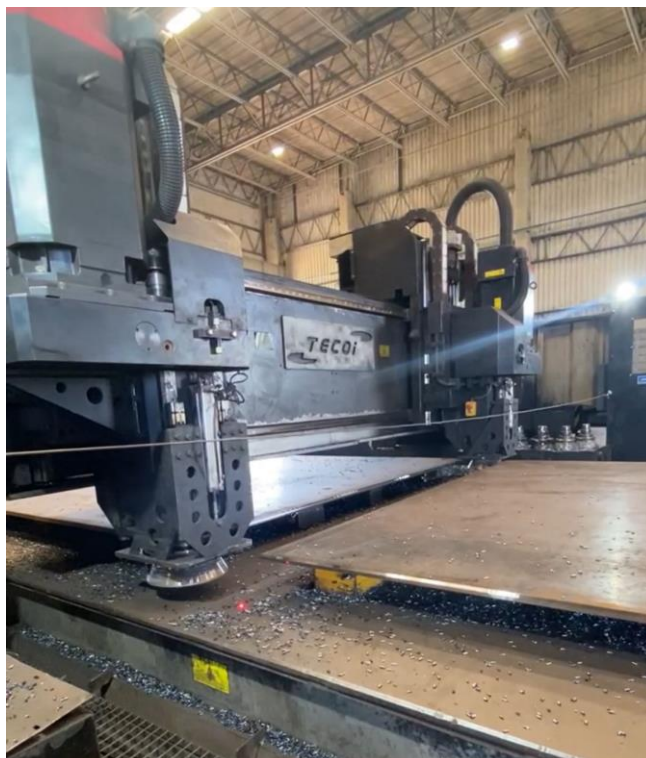
Figura 29 - Fresadora CNC TECOI utilizada no corte automatizado das chapas para virolas.
