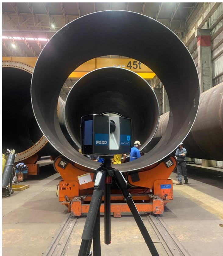
Figura 25 - 3D FARO Focus em preparação para medição da virola.
