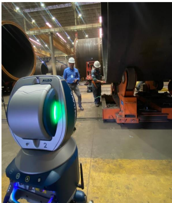
Figura 26 - Laser Tracker realizando medição interna de virola.
