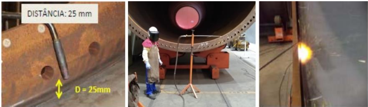
Figura 35 - Correção do tilt com calor.
