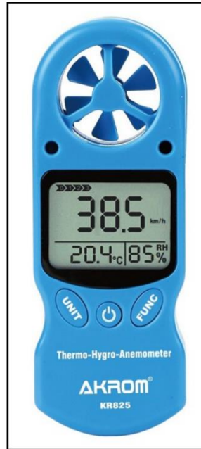
Figura 14. Modelo de Termo-higro-anemômetro utilizado para a aferição da velocidade do vento, umidade relativa e temperatura local. Foto da Internet.
