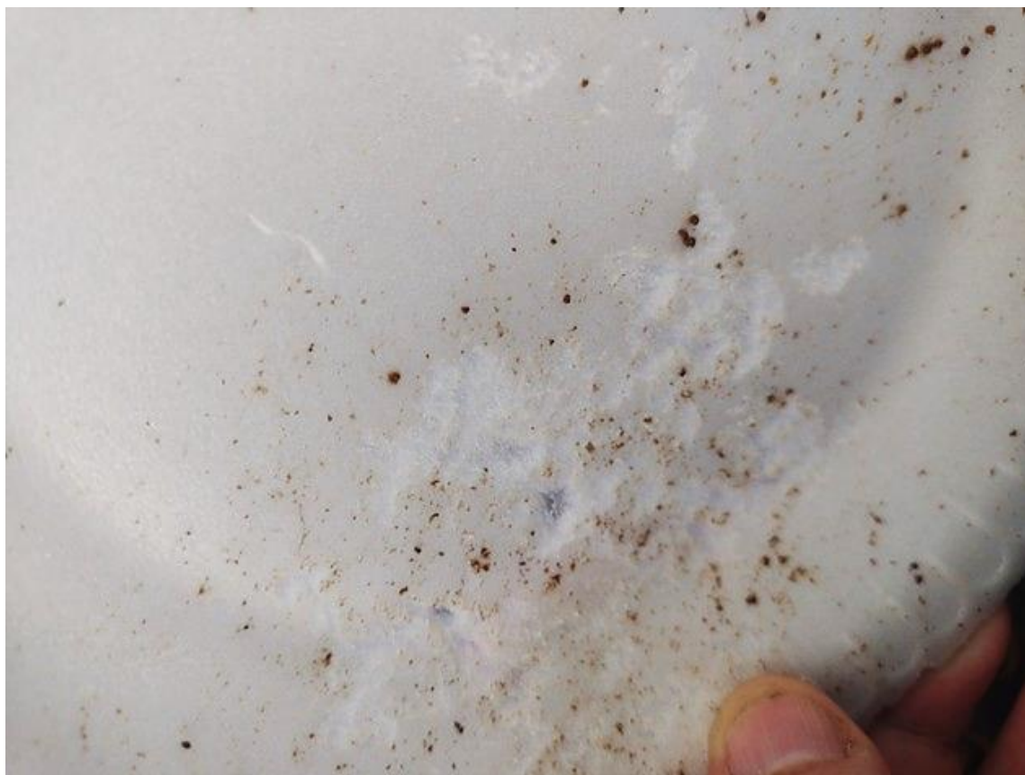
Figura 11. Imagem do interior de prato no terceiro dia de consumo, na caixa escura, T4 - réplica 2, mostrando a forte tendência à perfuração dos pratos.
