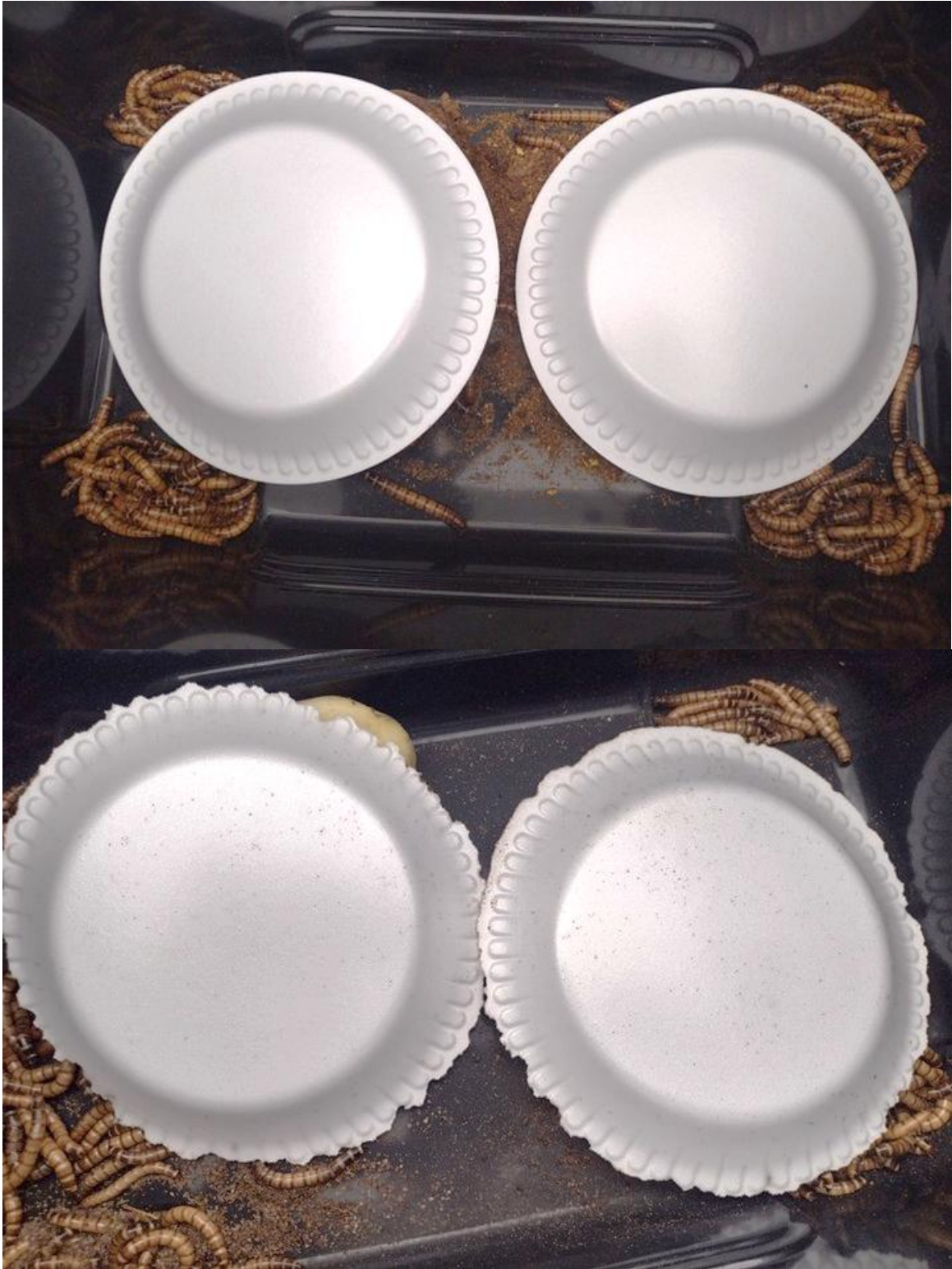
Figura 12. Comparação entre o consumo de plástico (T4 - réplica 2), no primeiro dia (acima), e no terceiro dia (abaixo).
