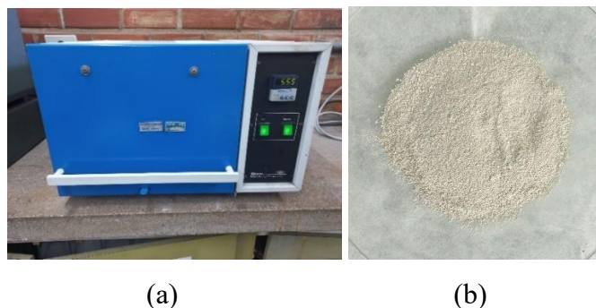
Figura 4: (a) Mufla Linn Elektro Therm, (b) Esterco calcinado.
