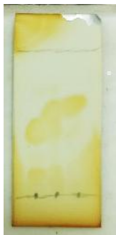
Figura 11: Acompanhamento por CCD da reação de síntese de biodiesel com catalisador heterogêneo a base de esterco de galinha após 2h de refluxo.
