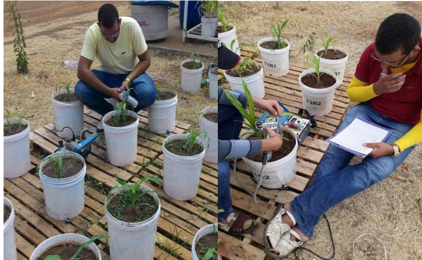
Figura 5: Medições da transpiração e da condutância estomática com porômetro em plantas de sorgo irrigadas com água salina.
