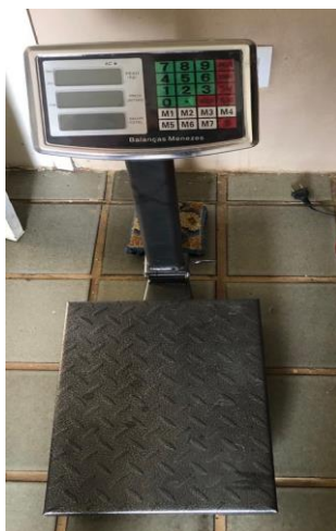
Figura 6: Balança digital plataforma industrial com suporte Menezes. Fonte: Acervo pessoal.
